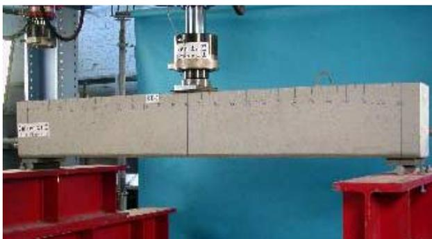
Abbildung 6: Der Stahlbetonbalken im Versuchsstand.
