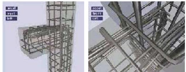
Abbildung 17 und 18: Bewehrungskorb einer Stahlbetonkonsole: Das interaktive 3D-Modell macht die Betrachtung der Bewehrung aus jeder Position möglich. Zum genaueren Verständnis kann in das Objekt hinein- und herausgezoomt werden.
